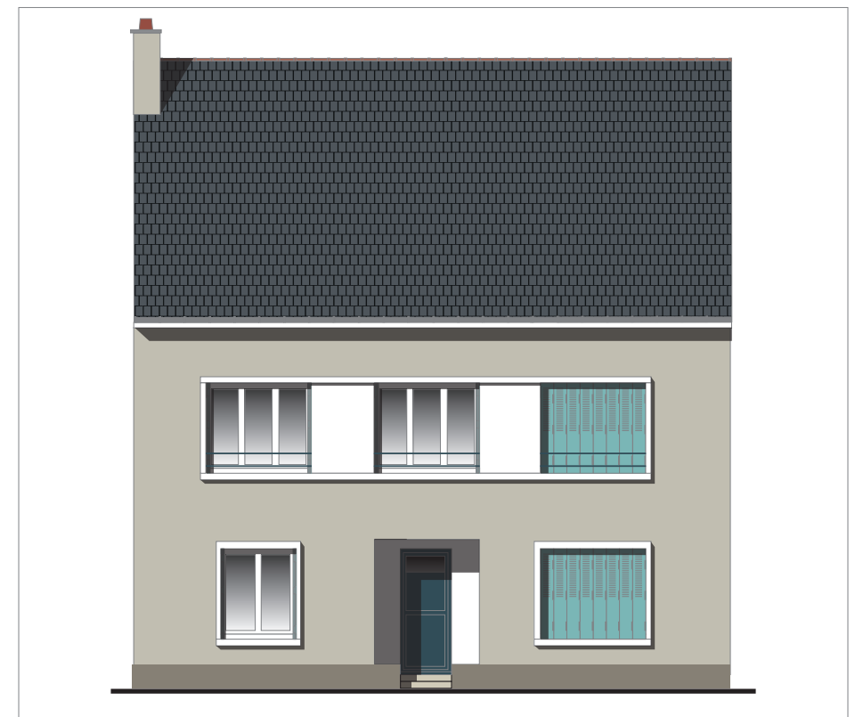
Maisons de ville d'après-guerre, marquage des parties entre baies et renforcement porte d'entrée
